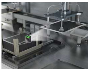
Phát hiện tấm vật liệu có khoảng trống kép
