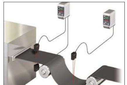
Đo độ dày/điều khiển vòng lặp của tấm cao su
