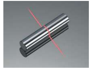
Đo tiết diện của calip đo lỗ bằng kim loại
