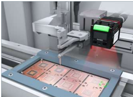
Màu sắc thay đổi do xử lý nhiệt đối với khung dây dẫn
