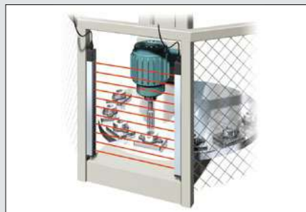
Có thể cần phải lắp đặt màn chắn quang ở hướng đảo ngược để thay đổi vị trí vùng chết
